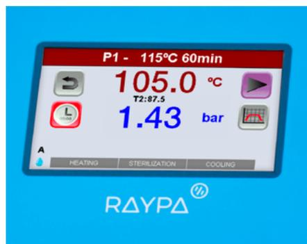
Microprocesador digital con pantalla táctil TFT de 5" para una fácil programación y selección de parámetros.
