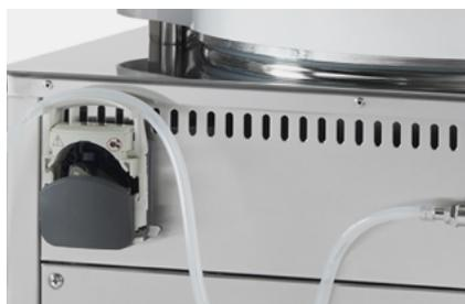
2. Revisar que la línea de dispensación no esté pinzada por la bomba peristáltica o la estación de dosificación externa.
