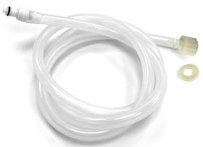
2 mangueras de silicona transparente de  $\varnothing 8 \times \varnothing 14$  mm y 1,5 m de longitud con conexión *racord* 3/8" a rosca (se incluyen las juntas) para conectar al equipo y, por el otro extremo, con conexión rápida para conectar al bidón.
