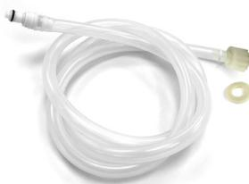
2 mangueras de silicona transparente de Ø8 x Ø14 mm y 1,5 m de longitud con conexión record 3/8" a rosca (se incluyen las juntas) para conectar al equipo y, por el otro extremo, con conexión rápida para conectar al bidón.
