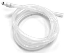
1 manguera de silicona transparente de  $\varnothing 5 \times \varnothing 8$  mm y 1m de longitud con conexión *press-fit* para conectar al equipo y, por el otro extremo, con conexión rápida para conectar al bidón.
