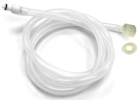
2 mangueras de silicona transparente de Ø8 x Ø14 mm y 1,5 m de longitud con conexión *racord* 3/8" a rosca (se incluyen las juntas) para conectar al equipo y, por el otro extremo, con conexión rápida para conectar al bidón.
