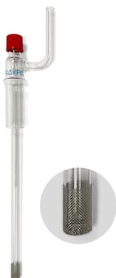
1 conjunto lavador compuesto por elementos de vidrio con tapón SUL-18 y junta de Ø8 x Ø18 mm.
