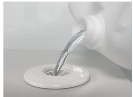
Accès au réservoir d'eau indépendant (3) situé dans la partie supérieure de l'autoclave.
