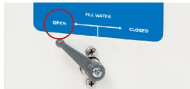
La vanne (4) doit être en position «OUVERTE» lors du remplissage de la chambre de stérilisation
