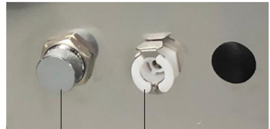
**1.** ACCÈS AU FILTRE D'ÉVACUATION ET À LA SORTIE DE VIDANGE DE LA CHAMBRE DE STÉRILISATION
